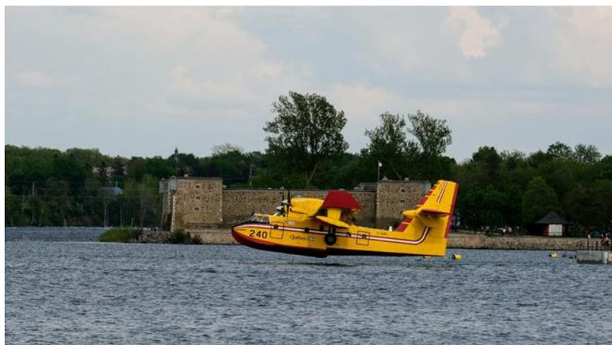
Un des 2 avions CL-415 recharge son réservoir d'eau sur le bassin de Chambly
